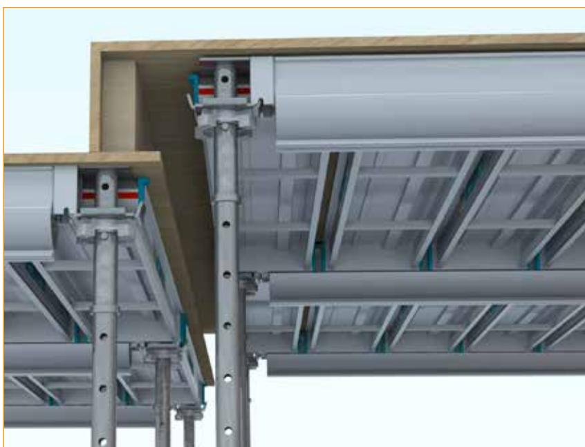
Les niveaux de dalles étant différents en sous-face, il convient d'approcher les 2 coffrages au plus près du décroché. Le vide sera ainsi limité à 20 cm, conformément au décret de 2004 relatif aux chutes de hauteur.
