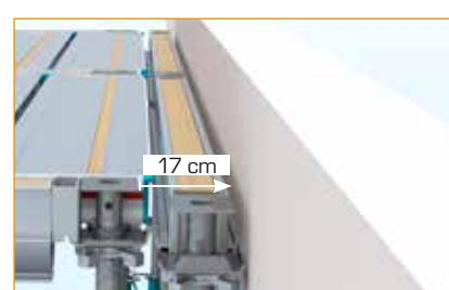
Au-delà de 17 cm de vide, il est possible d'insérer une poutrelle primaire sur des étais.
