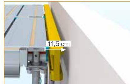
À partir de 11,5 cm de vide, il est possible d'insérer une poutrelle H2O sur des étais munis de fourches.
