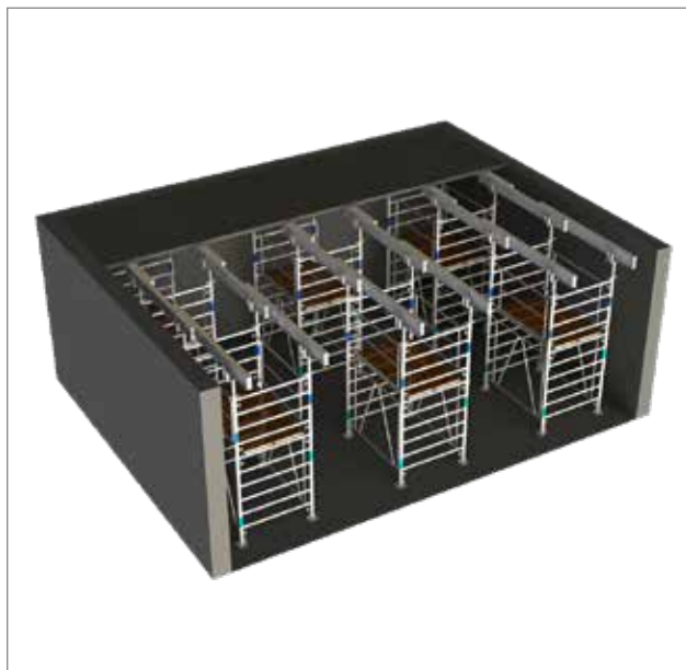
- Étalement pré-dalle alvéolaires AL200 sur tours A120.
