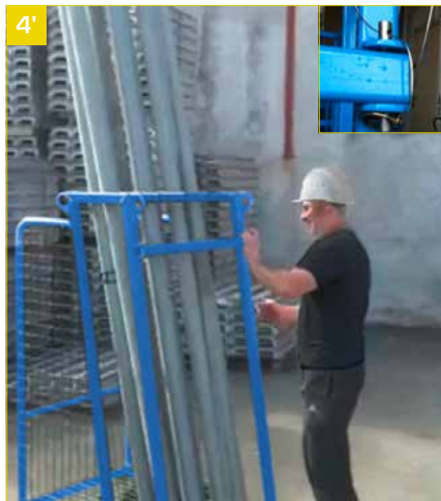
- Verrouillage par goupille imperdable.
