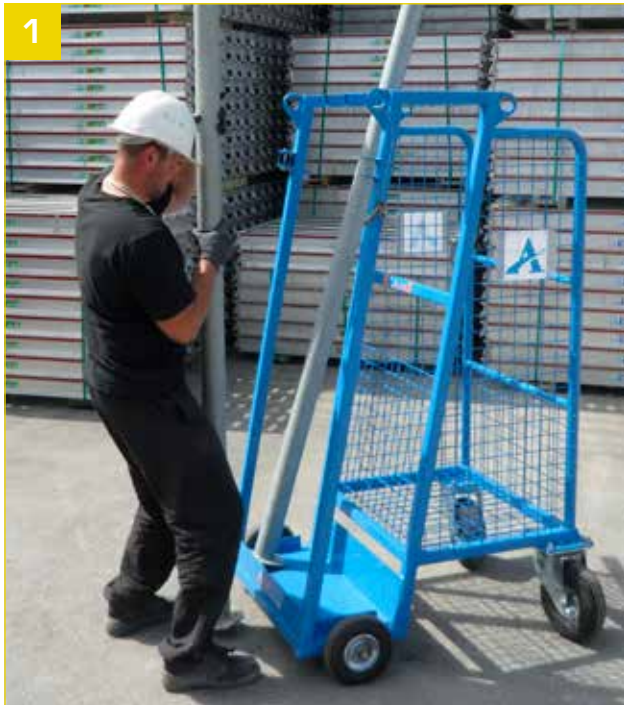
- Présentation des étais en position verticale.
