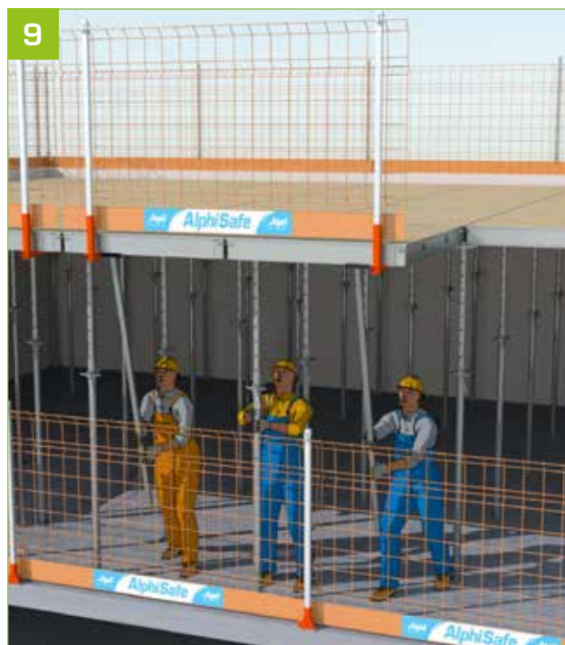
- Tout en maintenant les panneaux en place, venir étayer les panneaux suivant le mode opératoire MaxiDalle.
